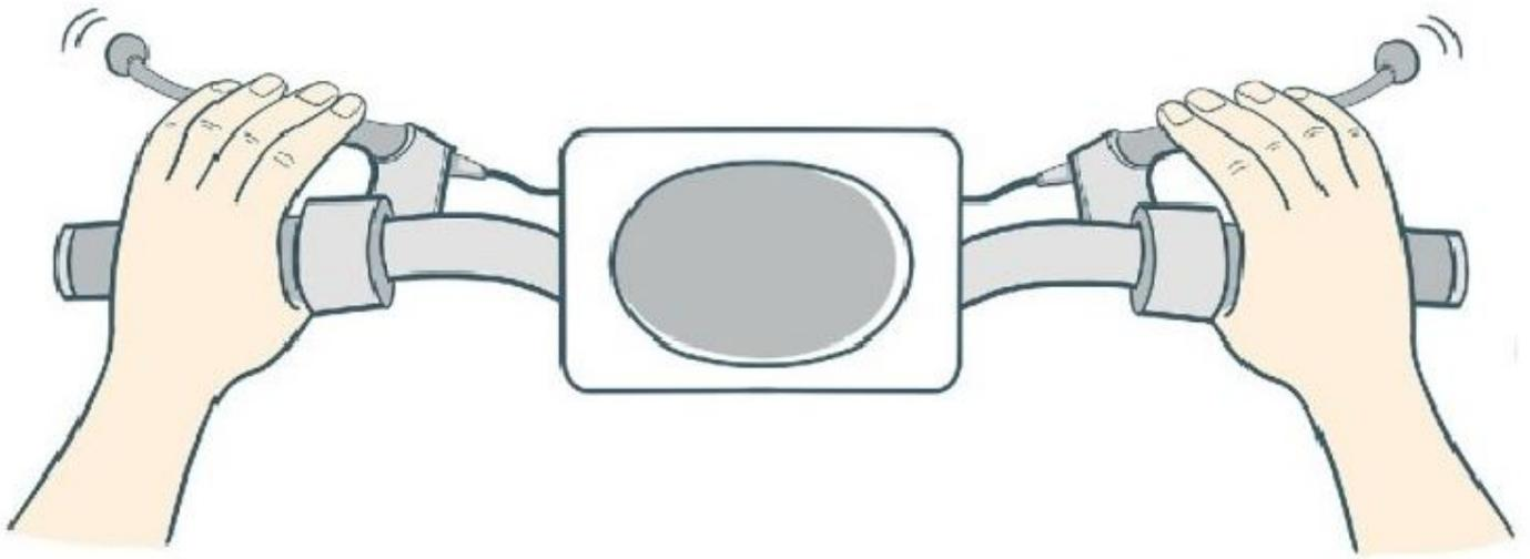
**注意：如果刹车断电开关工作，有可能无法启动电动车。**
