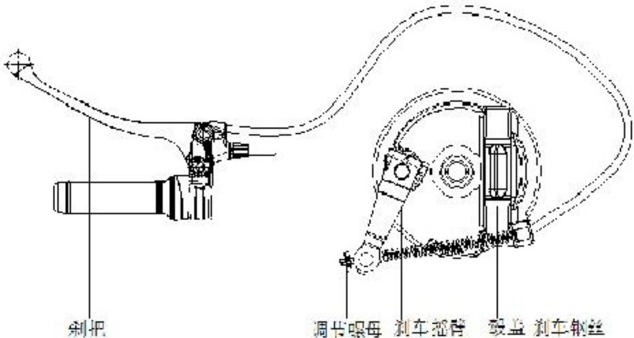
通过调整调节螺母来调节刹车灵敏度，达到制动器最佳制动效果的要求。
