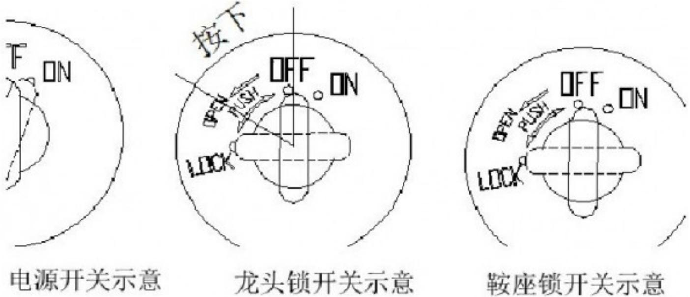
电源开启: 钥匙插入电门锁开关，向右顺时针旋转至ON位置，接通电源，钥匙不能被拔出。
